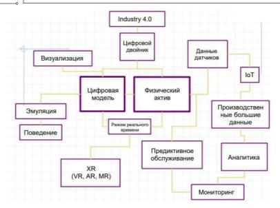
Рис. 6. Принципиальная схема взаимодействия элементов в Индустрии 4.0
