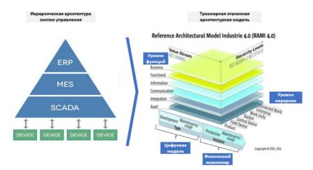
Рис. 18. Изменение архитектуры систем управления
