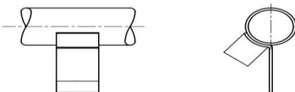
Узел присоединения заземляющего отвода из полосовой стали к трубопроводу (сварное соединение)
